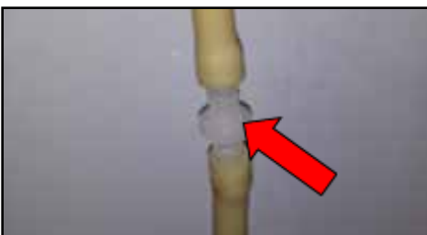
Raccord de tuyau pour rallonger le tuyau. Le tuyau de détartrage passe à côté des tuyaux chimiques.
